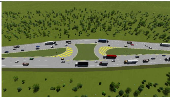
รูปที่ 6-4 รูปแบบจุดกลับรถระดับดินสำหรับรถขนาดใหญ่
