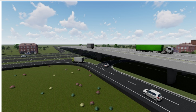
รูปที่ 8-3 จุดกลับรถได้สะพาน สำหรับรถขนาดใหญ่ (สูงไม่เกิน 5.50 เมตร)
