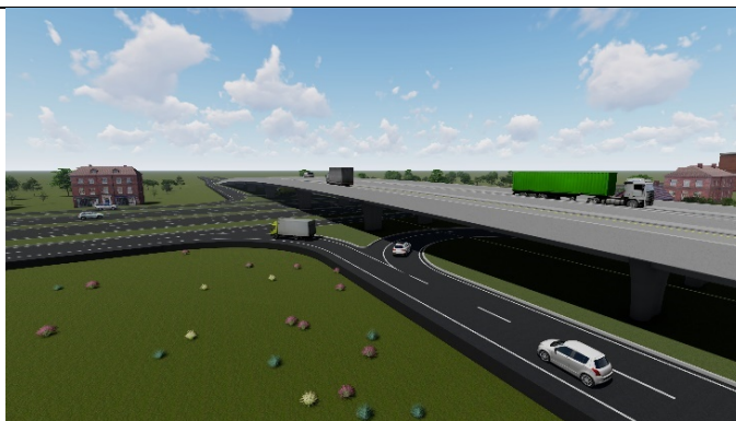
รูปที่ 6-5 รูปแบบจุดกลับรถได้สะพาน สำหรับรถขนาดใหญ่
